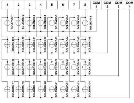
UP TO 32 CHANNEL SELECT COMMON 4 BY COMMON SELECTOR SWITCH
