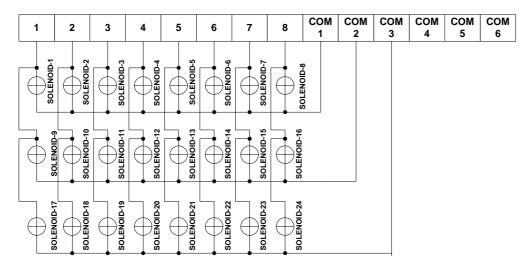
UP TO 24 CHANNEL SELECT COMMON 3 BY COMMON SELECTOR SWITCH
